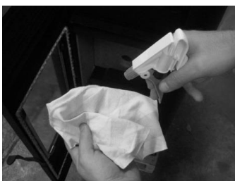
Figura 53 – Limpeza do vidro: Aplicar líquido no pano
