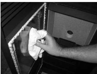
Figura 54 – Limpeza do vidro: Limpar o vidro com o pano
